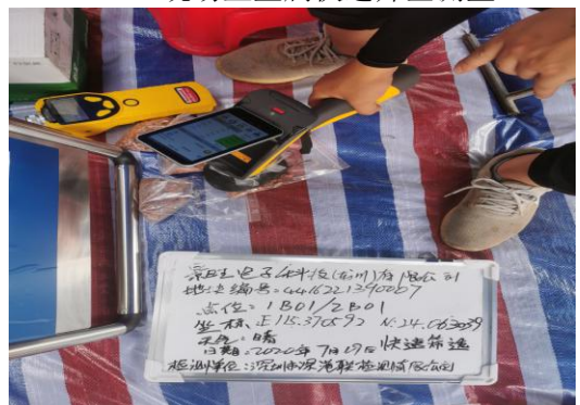
1B01 现场重金属快速筛查测量
