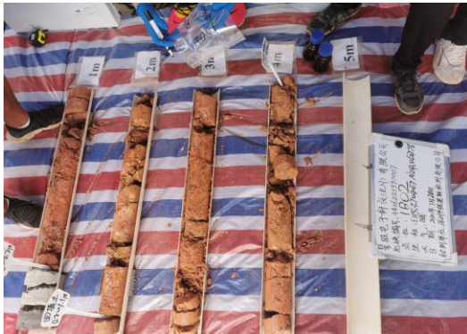
1B02-现场重金属快速筛查测量
