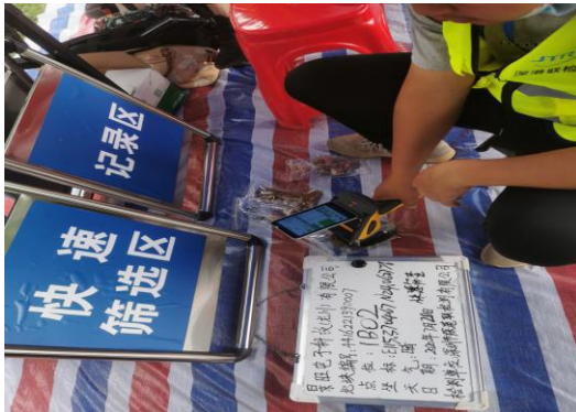
1B02-现场重金属快速筛查测量
