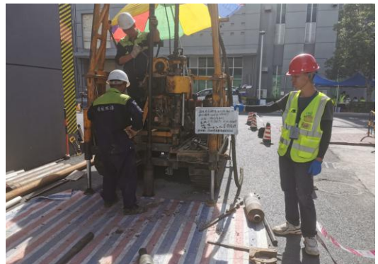
1B01 现场重金属快速筛查测量
