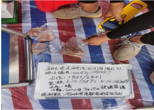
1B01 土壤半挥发性有机物样品取样
