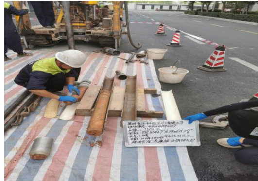
1B02-现场挥发性有机物快速筛查测量
