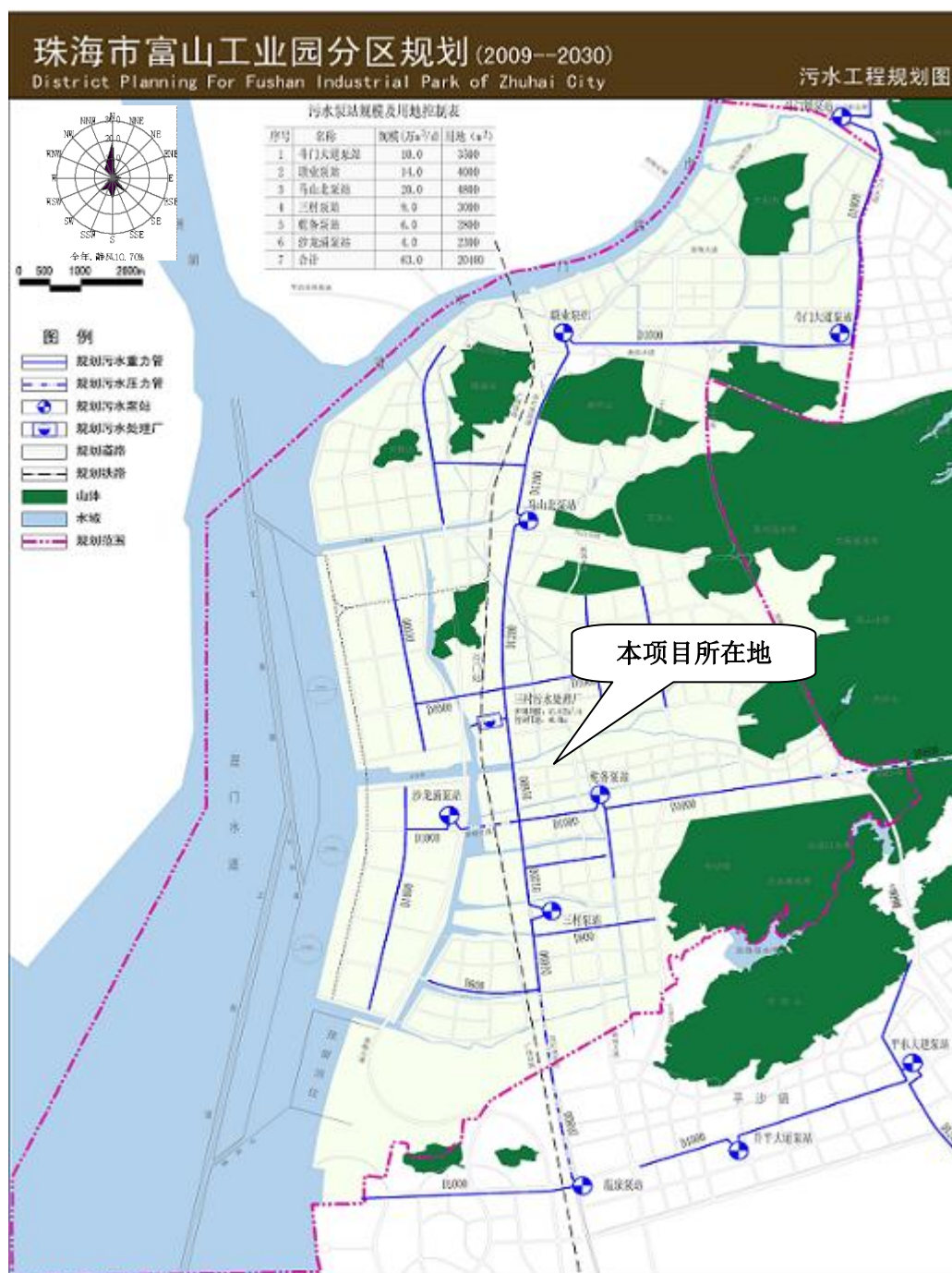
图 8.1-1 富山水质净化厂污水管网图
